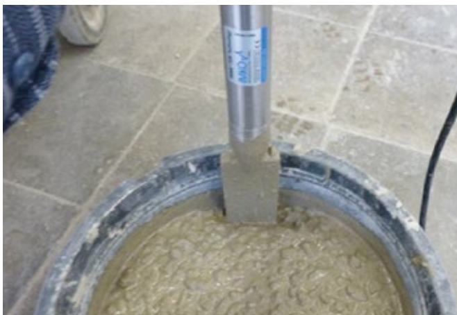
Abb. 1,2: Durchführung des Messvorgangs mittels Sono-WZ (Radar-Impulstechnologie) an einer Frischbetonprobe
