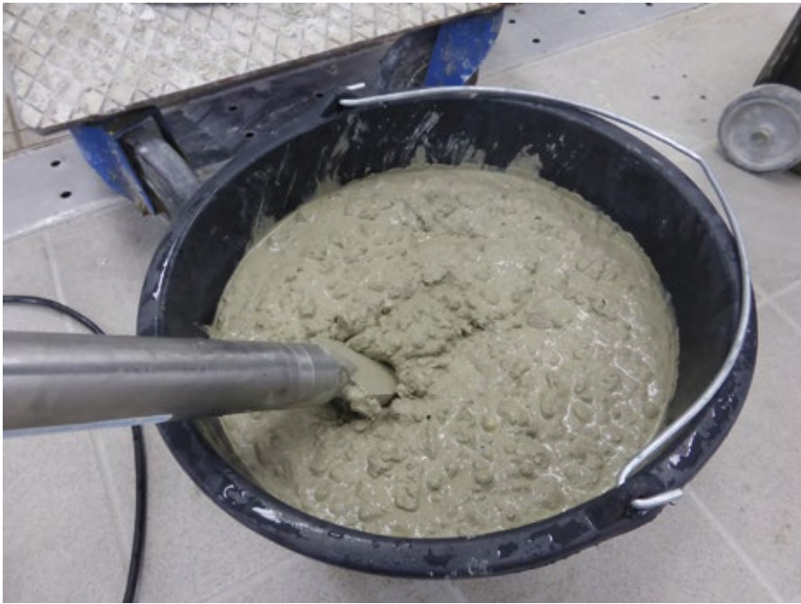
Abb. 4: Bei Betonen mit hohen Mehlkorngelalten, bzw. geringen Wassergehalten ist auf die vollständige Benetzung des Messfühlers besonders zu achten.
