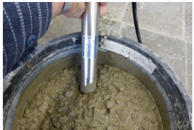
Abb. 1,2: Durchführung des Messvorgangs mittels Sono-WZ (Radar-Impulstechnologie) an einer Frischbetonprobe
