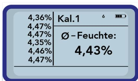
Dieser Messmodus eignet sich besonders gut zur Vermessung von großen Mengen Material, die abweichend vom Ort unterschiedliche Feuchten aufweisen können. Mit nur sechs Messungen im Betriebsmodus „Mittelwert“ erhalten Sie bereits ein repräsentatives Messergebnis.
