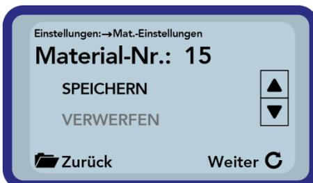
Anschließend kann die Kalibrierung unter dem zu Beginn eingestellten Speicher abgelegt werden („Speichern“). Erst mit Drücken der Taste „Messen“ wird der ausgewählte Speicher überschrieben. Um anschließend nachvollziehen zu können, welcher Speicher überschrieben wurde, wird der Originalname beibehalten, aber ein „OWN:“ vorangestellt.
