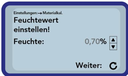
Anschließend wird die prozentuale Feuchte mit den Tasten „Hoch“ und „Runter“ eingestellt und ebenfalls mit der Taste „Messen“ bestätigt.
