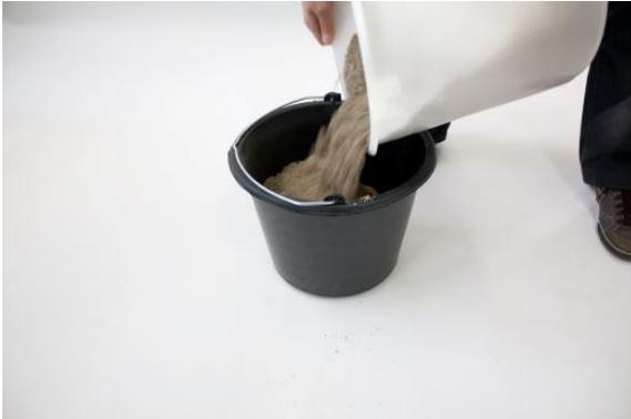
2. Sand durch 5-faches, senkrechtes anheben und auf den Boden fallen lassen des Behälters aus ca. 5cm Höhe verdichten (ist nach 5-maligem fallenlassen noch eine weitere Verdichtung des Materials erkennbar diese Prozedur weitere Male durchführen)
