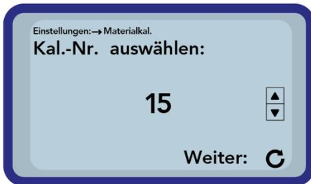
Zu Beginn der Kalibrierung muss der zu überschreibende Kalibrierspeicher (01 – 15) mit den Tasten „Hoch“ und „Runter“ eingestellt werden. Mit der Taste „Messen“ wird die Einstellung übernommen
