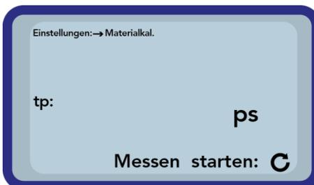
Um die Vermessung des Materials zu starten, betätigen Sie erneut die Taste „Messen“ . Um die Genauigkeit zu erhöhen, finden vier Messungen statt. Die Werte dieser Messungen werden anschließend gemittelt. Die Messzeit beträgt dabei etwa 20 Sekunden. Ist die Messung beendet, wird für einen kurzen Augenblick die gemessene Impulslaufzeit angezeigt.
