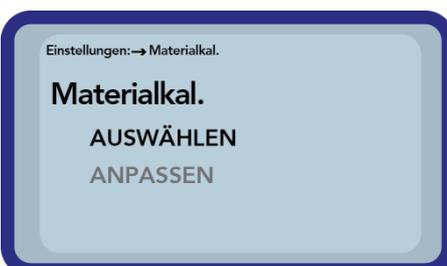
Nach Auswahl des Menüpunktes „Materialkal.“ wählen Sie zwischen „AUSWÄHLEN“, um eine der 15 Kalibrierungen einzustellen, oder „ANPASSEN“, um eine neue Kalibrierung auf einem der 15 Kalibrierspeicher vorzunehmen.
