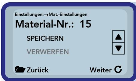
Anschließend kann die Kalibrierung unter dem zu Beginn eingestellten Speicher abgelegt werden („Speichern“).
