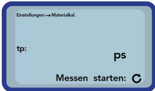
Um die Messung des Materials zu starten, drücken Sie die Taste "Messung"
