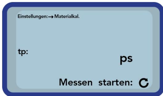
Um die Messung des Materials zu starten, drücken Sie die Taste "Messung"
