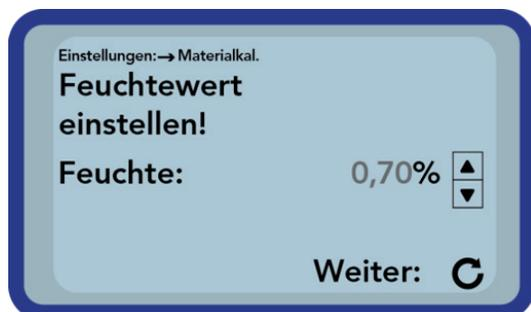
Stellen Sie anschließend die Materialfeuchte durch Drücken der Tasten "Hoch"
