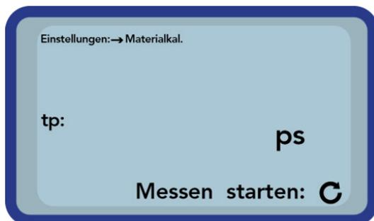
Um die Messung des Materials zu starten, drücken Sie die Taste "Messung" . Um die Genauigkeit zu verbessern, werden vier Messungen durchgeführt. Die Einzelwerte werden gemittelt. Die Dauer einer Messung beträgt etwa 20 Sekunden. Nach jeder Messung wird kurz die Signallaufzeit angezeigt.
