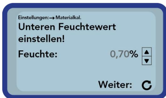
Stellen Sie anschließend die Feuchte des unteren Feuchtpunktes durch Drücken der Tasten "Hoch" und "Runter" ein.
