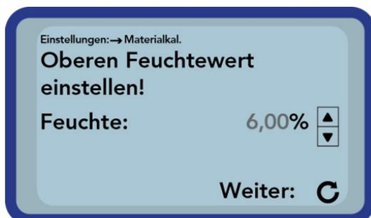
Stellen Sie anschließend die Feuchte des höheren Feuchtpunktes durch Drücken der Tasten "Hoch" und "Runter" ein.
