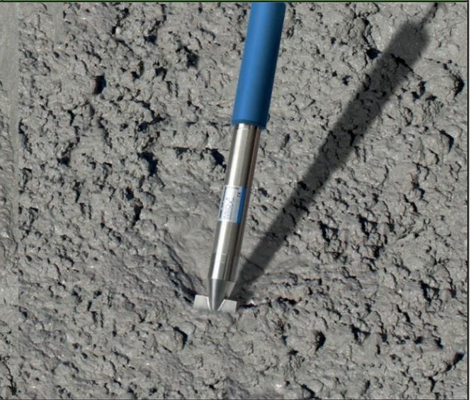
Beim mehrmaligen Einführen der Sonde an derselben Stelle besteht die Gefahr von Entmischungseffekten an dieser Stelle. Durch das Herausnehmen der Sonde aus dem Frischbeton wird der Raum mit feinen und flüssigen Partikeln gefüllt, die zu höheren Messwerten führen können.
