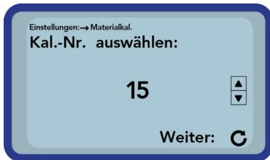
Zuerst müssen Sie die zu ändernde Kalibrierkurve (01 – 15) durch Drücken der Tasten "Hoch" und "Runter" auswählen.
