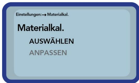
Nach der Auswahl des Menüpunktes "Materialkalibrierung" müssen Sie "AUSWÄHLEN" wählen, um eine von fünfzehn Kalibrierungen als Standardkalibrierung zu speichern oder „ÄNDERN“, um eine individuelle neue Kalibrierung in einem der fünfzehn Kalibrierspeicher anzulegen .
