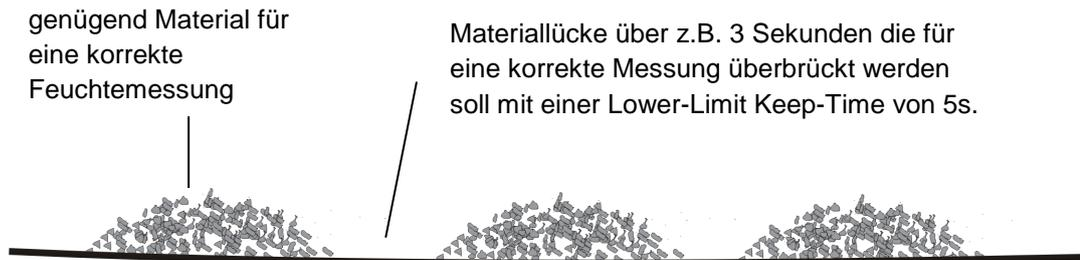
Nachfolgende Parameter-Einstellung in der Betriebsart CA oder CF eignet sich für diese Filterfunktion um Materiallücken überbrücken zu können.
