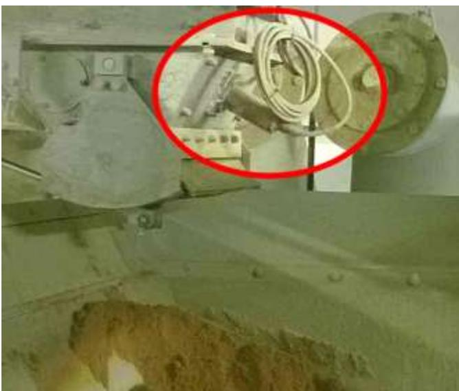
Im Bild ist zu sehen, wie „klebrig“ Sand sein kann, der an fast senkrechten Wandungen noch haften kann. Bei solch „klebrigem“ Sand ist ein Einbau im Silo nicht zu empfehlen, sondern unter der Siloklappe!
