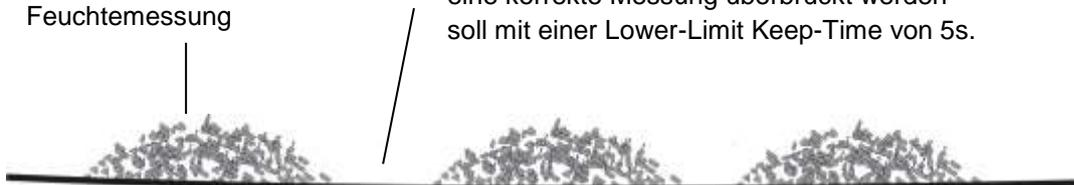
Nachfolgende Parameter-Einstellung in der Betriebsart CA oder CF eignet sich für diese Filterfunktion um Materiallücken überbrücken zu können.
