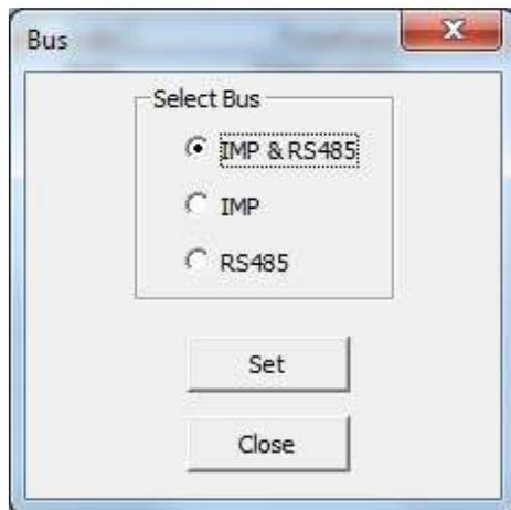
Im Fenster „**Probe List**“ kann unter dem Menüpunkt „**Config**“ im Fenster „**Measure Mode & Parameters**“ die SONO-Sonde auf die gewünschte Betriebsart CA bis CH (siehe Kapitel „Messmodus Konfiguration“) eingestellt werden. Weiterhin kann die serielle Schnittstelle in der SONO-Sonde auf IMP-Bus, RS485 oder auf beide Schnittstellen eingestellt werden. Empfohlen wird die Einstellung auf den robusten IMP-Bus.
