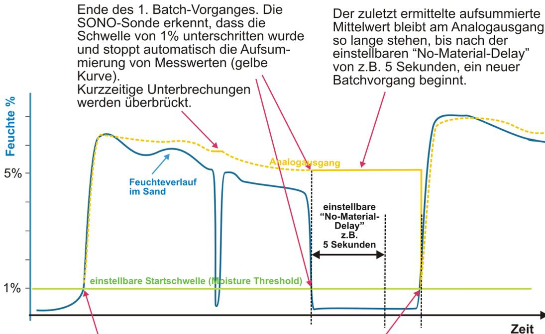
Start des 1. Batch-Vorganges. Die SONO-Sonde erkennt, dass die einstellbare Startschwelle von z.B. 1% überschritten wurde und beginnt automatisch mit der Aufsummierung von Messwerten (gelbe Kurve).
