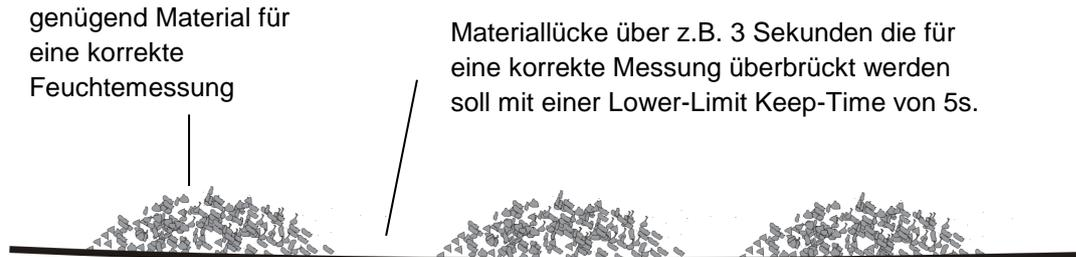
Nachfolgende Parameter-Einstellung in der Betriebsart CA oder CF eignet sich für diese Filterfunktion um Materiallücken überbrücken zu können.
