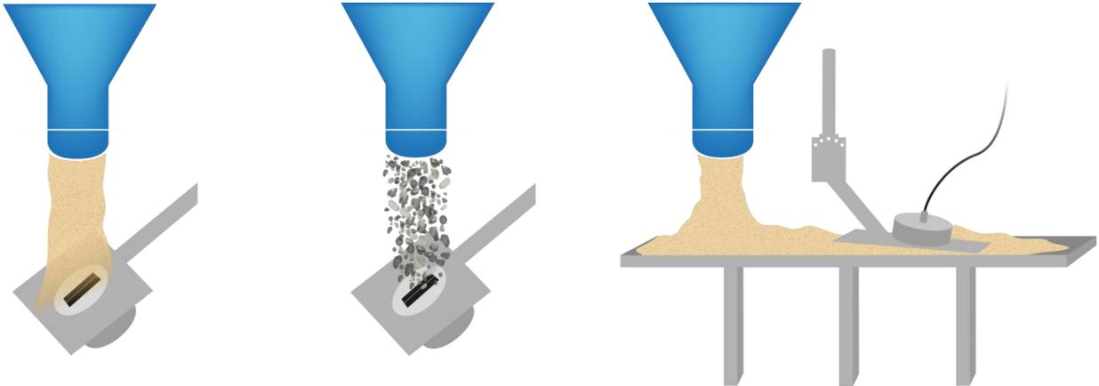
*Einbau der SONO-VARIO zur Messung von Schüttgütern unter einer Silo-Klappe oder auf einem Transportband. Wichtig ist, je nach Material, **den passenden Anstellwinkel der Halterung** zu finden. Dieser darf nicht zu steil, aber auch nicht zu flach sein. Weiterhin sollte beim Materialfluss **die Sondenoberfläche komplett bedeckt sein**.*
