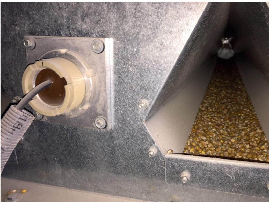
Prinzipiell ist der Einbau direkt an der Abluftseite der Trocknerwand möglich. Dieser Einbauplatz hat jedoch mehrere Nachteile:
