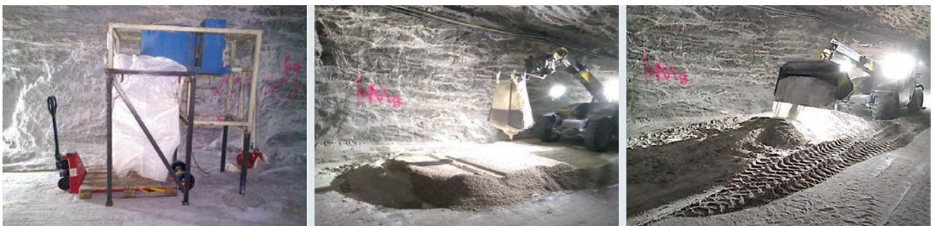
Drei Phasen der Mischung eines gefügestabilisierten Salzgrusversatzes im laufenden FuE-Projekt
