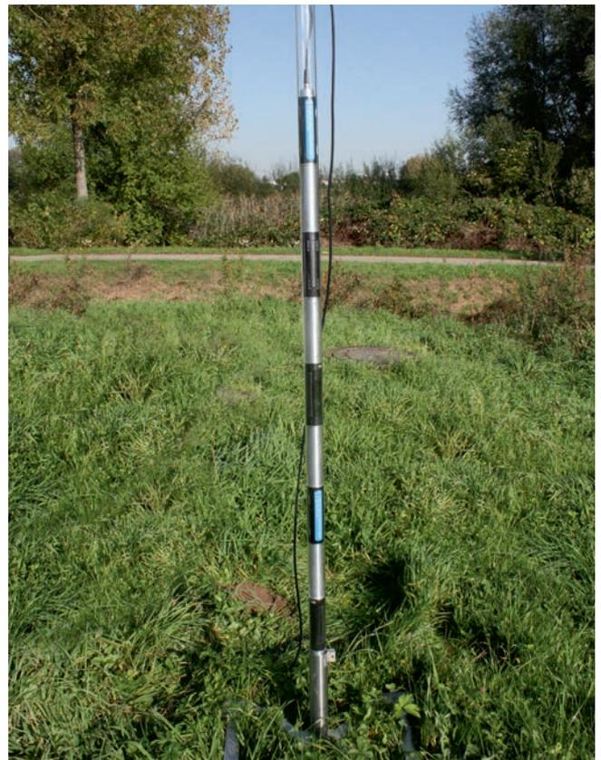
Die PICO T3PN ist der perfekte Ersatz für eine Lysimeter-Installation, da mit einem frei konfektionierbaren Sondaufbau verschiedene Tiefen eines Bodenprofils hinsichtlich der vorliegenden Bodenfeuchte bewertet werden können.
