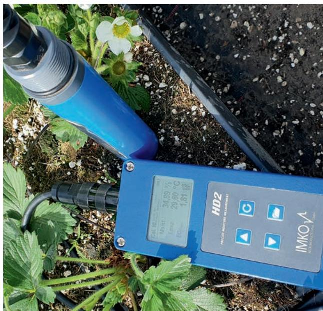
Anbau von Folienerdbeeren im Freiland / Messung der Bodenfeuchte mit dem HD2 von IMKO
