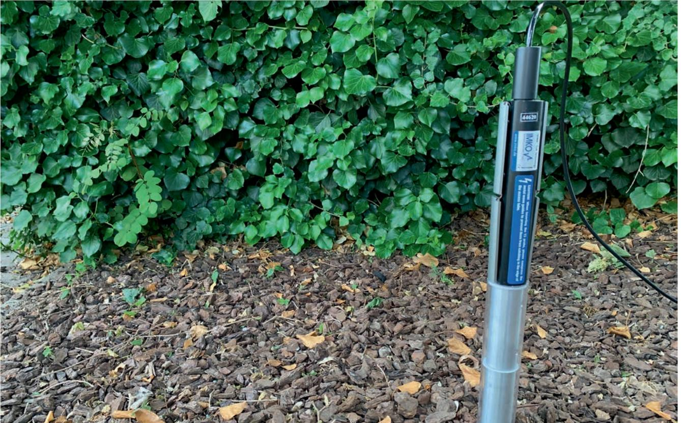
Installation einer PICO T3PN am Demofeld Reutgraben – Vergleichsmessung mit PICO32 / PICO64 am Standort – Visualisierung per Microcomputer und Web-Application
