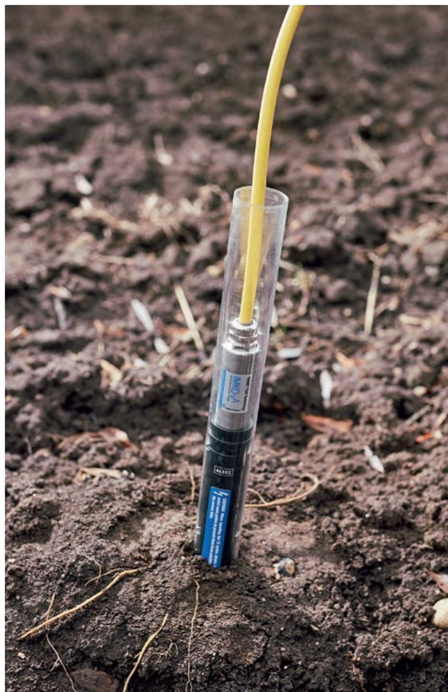
Exemplarische Darstellung des Einbaus der IPH2 im ungestörten Unterboden – mittig ist das Polycarbonat-Spezialrohr zu erkennen
