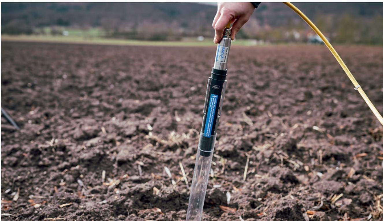
Messung mit der PICO IPH2 an einem vorinstallierten Polycarbonat-Spezialrohr
