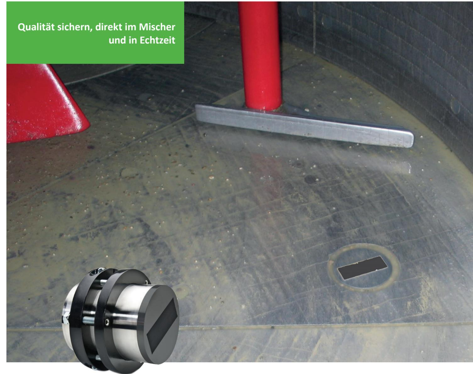
Basierend auf der revolutionären TRIME Radartechnik ist es möglich den Wassergehalt hochgenau in Mischern zu messen: Ohne Messwertdrift über den Verschleiß der Sonden
