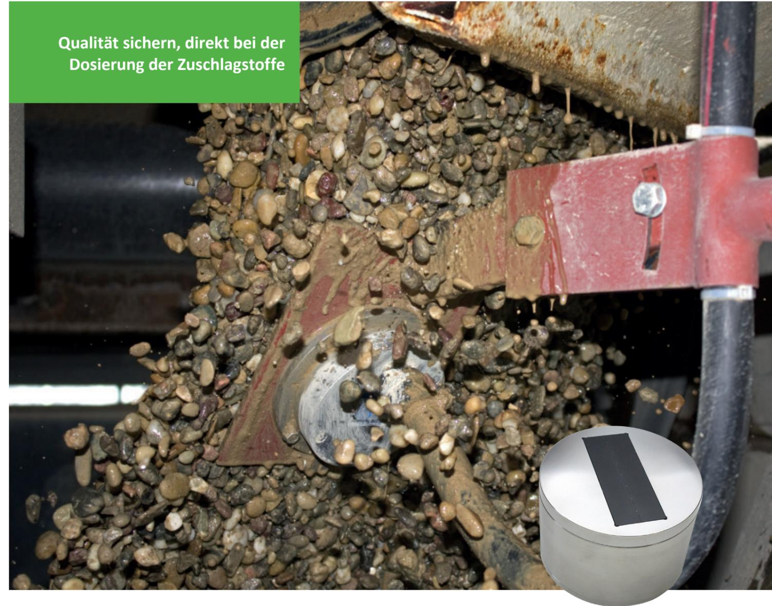
Basierend auf der revolutionären TRIME Radartechnik ist es möglich den Wassergehalt hochgenau bei der Dosierung von Zuschlagstoffen zu messen: Ohne Messwertdrift über den Verschleiß der Sonden
